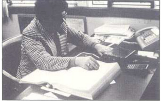
Optacon, aparelho baseado no princípio Visuo-Táctil, análogo ao Electrovisor.
