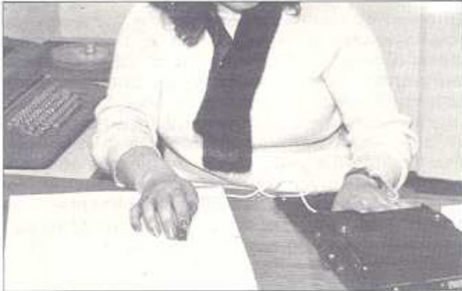
Outro pormenor do Optacon: a câmara de televisão percorre as linhas do texto e a imagem das letras é sentida pela pessoa cega no dedo indicador da mão esquerda.
